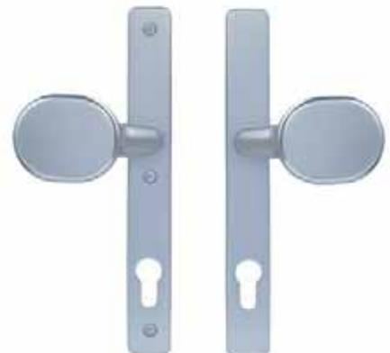
Rahmengarnitur 30 aus hochwertigem Aluminium, Clip-Deckschilder auf massiver Druckguss-Unterkonstruktion mit Kugelrasterung aufgeclipst, verdeckte M5 Verschraubungen, Vierkantmass 8mm, Rückholmechanik - Innenseite - Innengarnitur.
